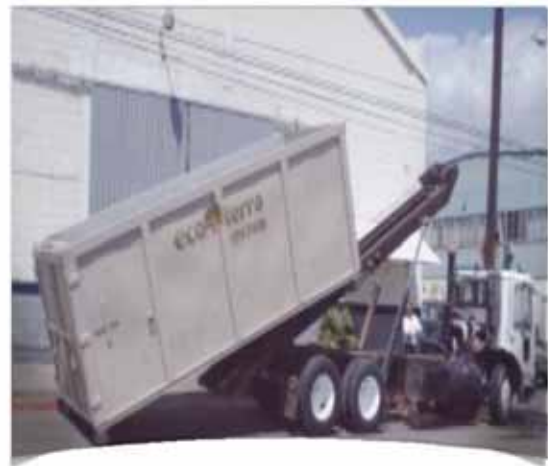
Imagen 7: Recogida mediante intercambio de contenedores.
