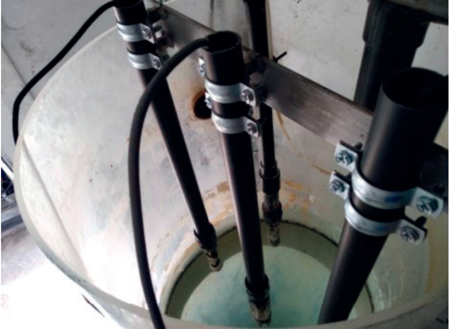
Figura 9: Detalle de las sondas y sistemas de medición en uno de los biorreactores.
